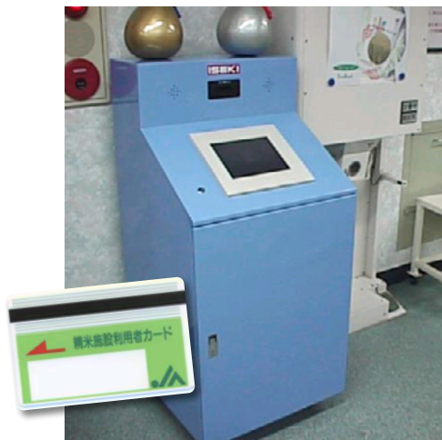
お米引き出し機「うまいっこちゃん」 に精米施設利用者カードを挿入する と、お米を引き出せる仕組み
